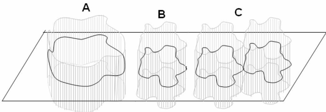
Um plano paralelo às bases dos prismas a uma altura qualquer gera nos prismas A e C uma secção que tem o dobro da área da secção gerada em B e, por construção, também gera em C uma secção que tem o dobro da área da secção de B logo, pelo Princípio de Cavalieri, os sólidos A e C têm mesmo volume.
