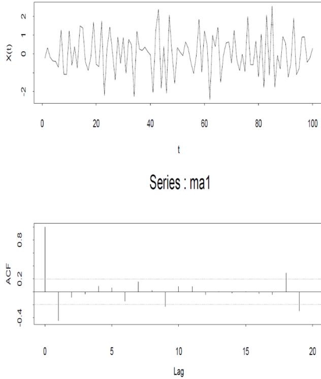
Figura 2.8: Processo MA(1) simulado,  $\theta = 0,8$  e f.a.c.
