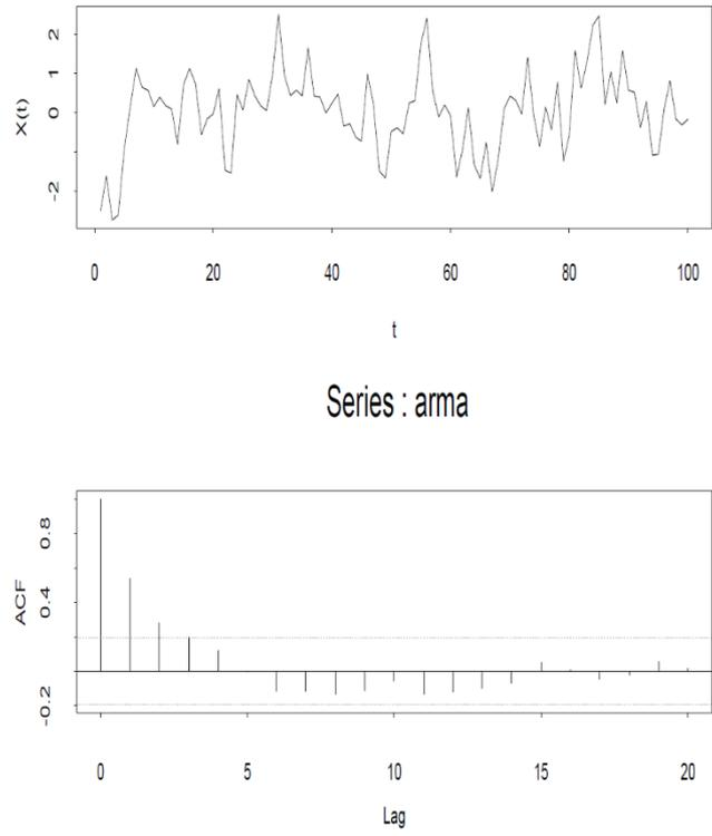
Figura 2.9: Processo ARMA(1,1) simulado,  $\phi = 0,8, \theta = 0,3$  e f.a.c.
