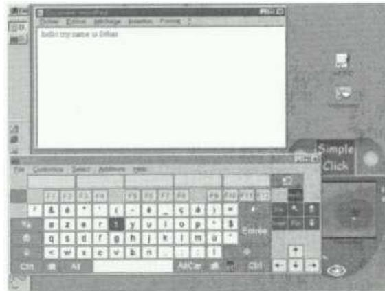
Figura 6: VISIOBOARD[2001], Sistema de digitação através do olhar.
