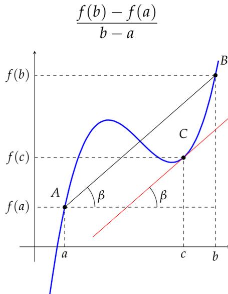
A figura acima nos sugere que entre  $A$  e  $B$  deve haver algum ponto  $C = (c, f(c))$  sobre o gráfico, onde a reta tangente à curva seja paralela à secante  $AB$ . Desta forma, os declives da reta secante e da reta tangente (em vermelho) serão iguais. Como o declive da reta tangente é  $f'(c)$ ,
