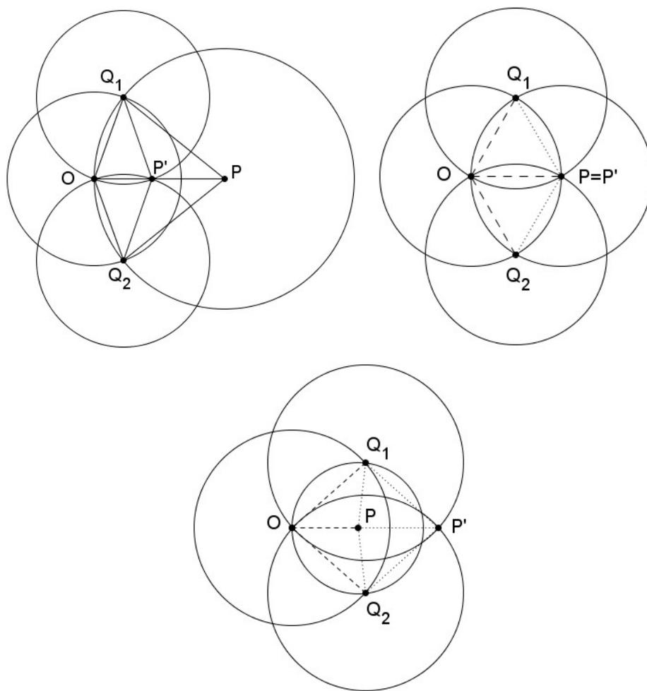
Figura 8: Construção da inversão  $P'$  de  $P$  usando compasso: caso em que a circunferência de centro  $P$  e raio  $PO$  intersecta circunferência de inversão em dois pontos.
